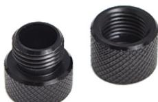
Schutzkappenset für zweite Stufen: Die eine Kappe kommt auf den Anschluss der demontierten zweiten Stufe, die andere Kappe auf den Schlauch, der sonst an die Stufe angeschlossen wird. So werden beide Seiten geschützt.
